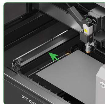
(7) Inserte el lado izquierdo del material en el dispositivo de fijación izquierdo.
