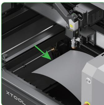
(6) Mueva el dispositivo de fijación izquierdo hacia la derecha.
