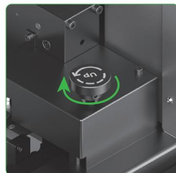
(3) Gire la perilla en el sentido de las agujas del reloj para apretar el dispositivo de fijación derecho.
