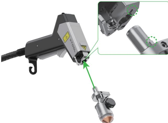
Alinee la pestaña de la punta de corte con la ranura en el cabezal de soldadura y luego inserte la punta de corte.
